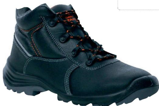
Visoke cipele. Gornjište : goveđa koža, vodoodbojna obrada S3. Podstava : poliamid „mesh“. Unutarnji uložak: unaprijed oblikovan, na vađenje - mesh na poliuretanskoj pjeni. Potplat: duplobrizgani poliuretani.
