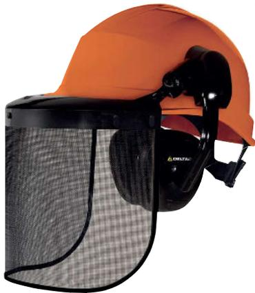
Zaštitna šumarska kaciga koja se sastoji od : Kacige ZIRCON : polipropilena (PP) ili od polietilena visoke gustoće (HDPE), UV zaštita. Znojnika za čelo. Unutarnje trake od polietilena (LDPE) s 8 točki pričvršćenja. Antifona SUZUKA2. Nosača vizira VISOR HOLDER. Vizira sa čeličnom mrežicom VISORG. Pakiranje - kartonska kutija.
