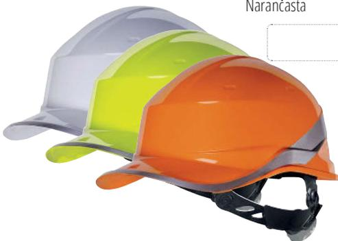
Građevinska kaciga od ABS-a. Inovativan oblik baseball kape koji omogućuje veću vidljivost u visinu. Testirana za nošenje s prednje ili stražnje strane. Unutarnje trake od poliamida: 3 tekstilne trake s 8 točki pričvršćenja. Znojnik za čelo. Inovativni sustav podešavanja širine gumbom "color to color". Opseg glave podesiv: od 53 do 63 cm. Dvije moguće pozicije opsega glave ( gornja / donja ) radi veće udobnosti. Električna izolacija do 1000 VAC ili 1500 VCC.
