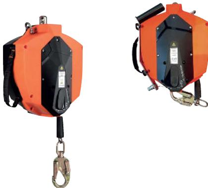
Protektor s automatskim zaustavljanjem pada, sa užetom od nehrđajućeg čelika, Ø 5 mm. Vitlo za spašavanje sa ručkom na skidanje. Kućište od ABS-a. Sustav blokiranja po inerciji. Apsorber energije. 1 automatska okretna spona s indikatorom pada, otvor 21 mm.
