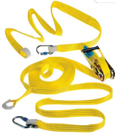
Traka za instaliranje privremenog horizontalnog sustava za zaštitu od pada. Sustav je certificiran za dvije osobe. Podešavanje dužine i napona pomoću napinjača. Uključene dvije sponne AM002 te torba za spremanje opreme.
