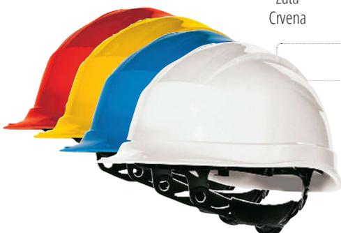
Građevinska kaciga od polipropilena ( PP ), visoko otporna, UV zaštita. Unutarnje trake od poliamida: 3 tekstilne trake s 8 točki pričvršćenja. Znojnik za čelo. Inovacijski sustav podešavanja širine Rotor®: opseg glave podesiv od 53 do 63 cm. Dvije moguće pozicije opsega glave ( gornji i donji ) radi veće udobnosti. Električna izolacija do 1000 VAC ili 1500 VCC.
