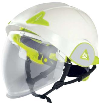
Građevinska kaciga s dvostrukom školjkom od ABS-a te polikarbonatnim vizikom na uvlačenje. Dinamičan i sportski dizajn. 3 tekstilne trake sa 6 točaka pričvršćenja. Spužvica za čelo. Opseg glave podesiv od 53 do 64 cm pomoću gumba Rotor One-D. 2 moguće pozicije opsega glave (visoka/niska) za veću udobnost. Reflektirajuće naljepnice. Električna izolacija do 1 000 VAC / 1 500 VCC, zaštita od električnog luka klasa 1 (GS-ET 29).
